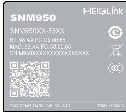
SNM950 系列模组基于高通骁龙 800 系列 QCS8250 平台开发的智能模组。该平台集成高通 8 核 Kryo™ 585 CPU (1x Kryo Gold Prime core at 2.85GHz + 3x Kryo Gold core at 2.4GHz + 4x Kryo Silver core at 1.8GHz) ，采用 7nm 制程。集成高通 Adreno™ DPU 995,显示分辨率最大可以支持到双 4K。集成高通 Adreno™ VPU 665,最高支持 4K@120fps 视频编码或 4K@240fps 视频解码,支持 H.264/H.265。集成高通 Adreno™ GPU 650, 支持 OpenGL ES 3.2, Vulkan1.1, 支持 OpenCL 2.0。集成高通神经网络处理单元 NPU230, AI 算力可达 15 Tops。
