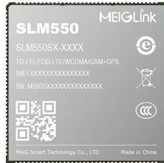
SLM550S 系列模组，采用紫光展锐的 UIS8581E 平台，该 CPU 采用 28nm FinFET 制程，内置 64bit ARM、8 核 A55 (4\*1.6GHz+4\*1.2GHz)，支持 Decode/encode 最高 1080P@30fps、H.266，支持 FHD+ 屏幕分辨率，支持两路 ISP 摄像头，搭载 Android 10 操作系统，支持板卡内存为 1GB+8GB (2GB+16GB、3GB+32GB、4GB+64GB)，支持 LTE Cat4，最大下行速率可达 150Mbps，最大上行速率可达 50Mbps。支持 TD-LTE/FDD-LTE/WCDMA/TD-SCDMA/GSM 多种网络制式，集成了 GNSS 和 2.4WIFI (5G WIFI 选配)。
